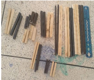
Figure 1: Barras paralelepípedas (madera/hierro), longitudes (20/10/5 cm), ancho (15/10/7 mm)
